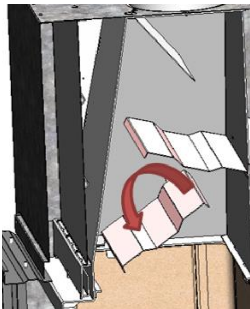
Figura n°32 - Desmontaje del deflector medio Itaca 80
